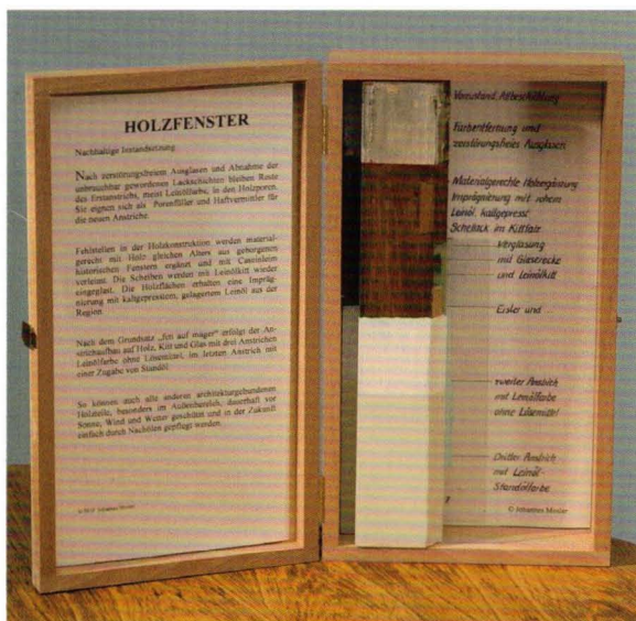
Abb. 5 Anstrichaufbau mit Leinölfarbe
