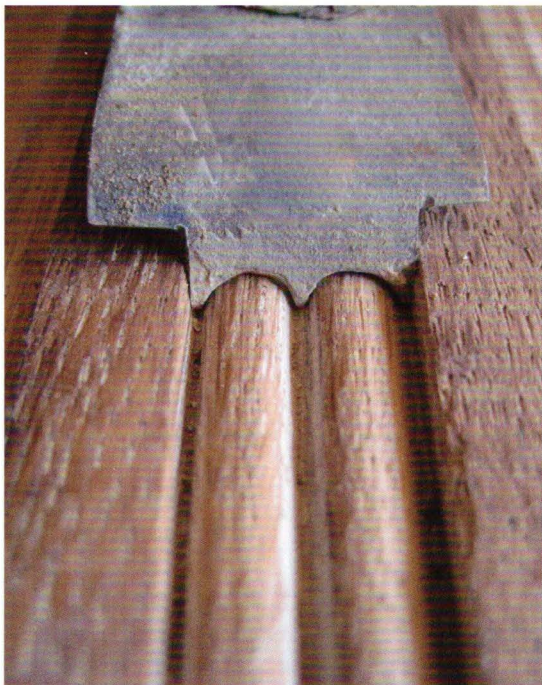
Abb. 4 Schaber für profilierte Bauteile
